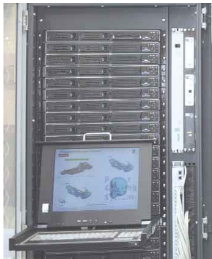
CMC-TC im neuen Rittal Power System Rack mit integrierter Stromversorgung und Flüssigkeitskühlung.
