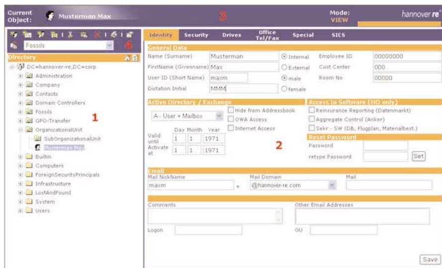
Abbildung 1: Web-basierte Mitarbeiterverwaltung mit der Hannover Rück Administration Console (HAC) – 1 Ein »tree view« ermöglicht die Navigation im Verzeichnis – 2 Ein »details view« zeigt die Detailinformationen zum ausgewählten Objekt – 3 Die »status bar« hebt die gerade durchgeführte Aktivität hervor – 4 Die »tool bar« ermöglicht den vereinfachten Zugriff auf häufig genutzte Funktionen
